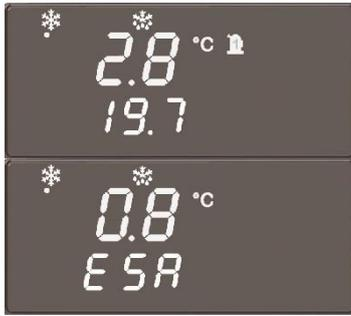
Bei normaler Betriebskondition sieht der Kontrolleur auf dem Display oben die Temperatur des DEW POINT (Taupunktes), unten die RAUMTEMPERATUR.
