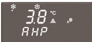
Von einer normalen Kondition (keine Alarm) ausgehend, zeigt das Gerät, sobald es einen Alarmzustand registriert, **unten auf dem Display** den Alarmcode und das entsprechende Symbol, das abwechselnd mit dem der Temperatur blinkt, an. Der Summer wird aktiviert.
